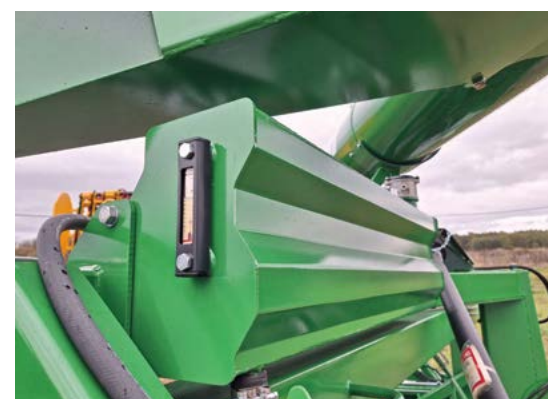
Дополнительный масляный бак с термометром
