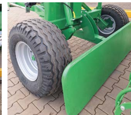
Защитный выступ, предотвращающий удары колес об мешок
