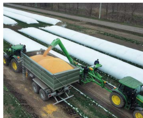
Высота выгрузки из рукава 4,3 м.
