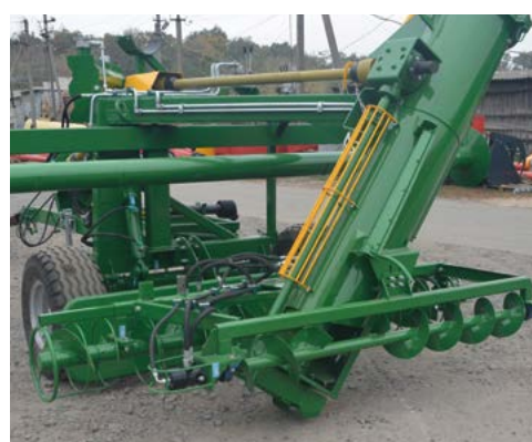
Дополнительный горизонтальный шнек для обрушения кукурузы
