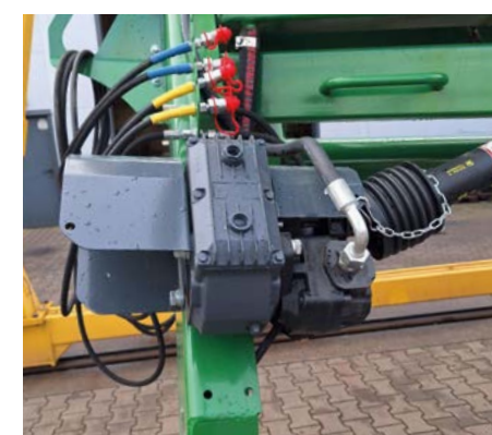
Автономная маслозаправочная станция. Для увеличения подачи масла на гидромотор.
