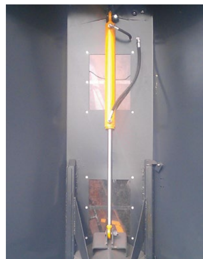
Хидраулични поклопац за затварање сврдла за зрно
