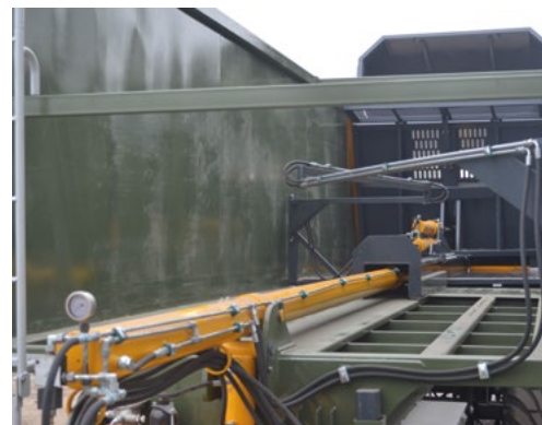
Хидраулички систем покретног зида
