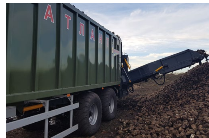
Пилер за репу до висине 3,0 м.
