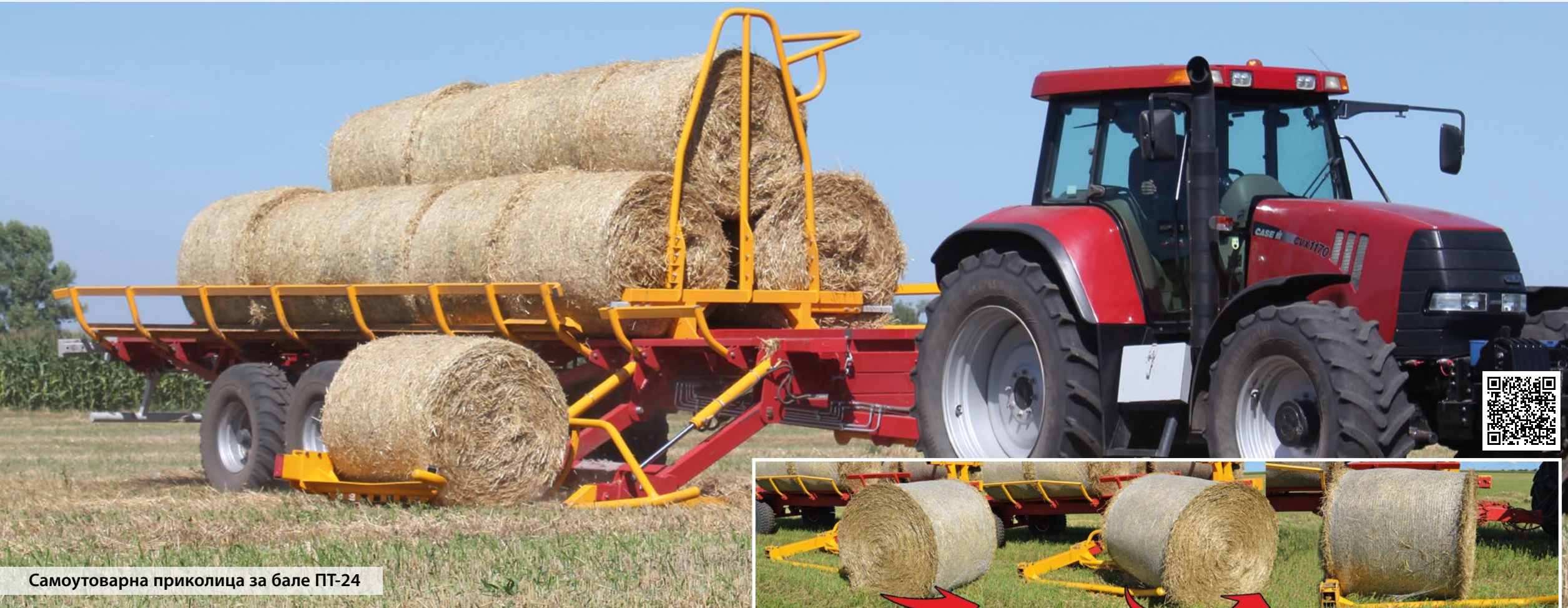
Универзална хидраулична шапа у покрету развија ролну и оптерећује платформу
