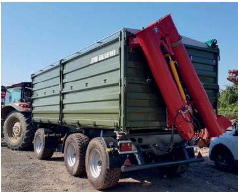
Шнек за ремарке със задно разтоварване
