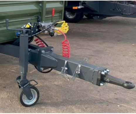
Механична опора на теглич с колело ТСП-6т
