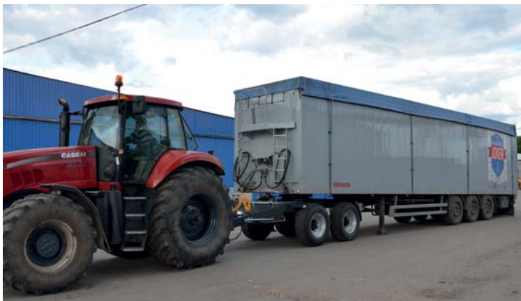
Връзка на Dolly ПСП-20 с полуремарке и трактор
