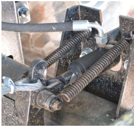
Хидравлична спирачна система
