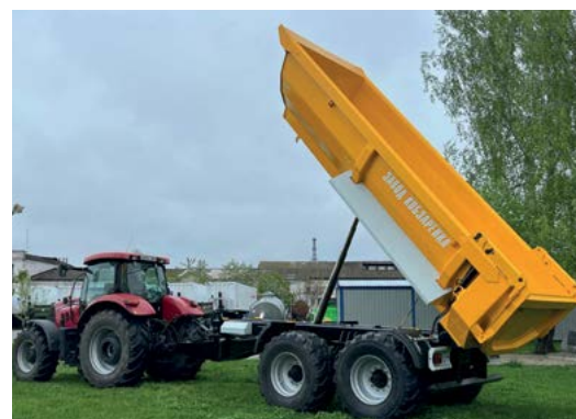
Телескопичен хидравличен цилиндър DiNatale (Италия)
