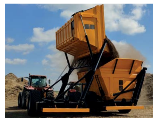
Максималната височина на разтоварване е 4000 mm
