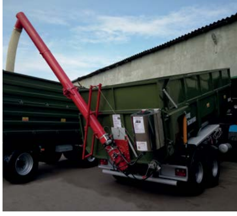
Шнек на ремарке със задно разтоварване
