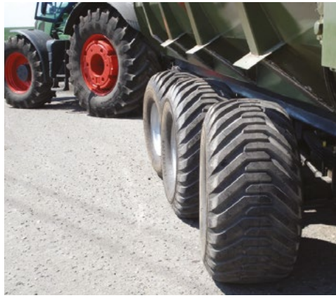
Прва и последња осовина су позитивно управљане
