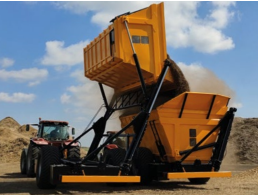
Максимална висина истовара је 4.000 мм
