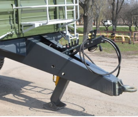
Хидраулични носач вучне траке ТСП-10т, ТСП-16т
