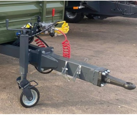
Механички носач вучне руде са точком ТСП-6т
