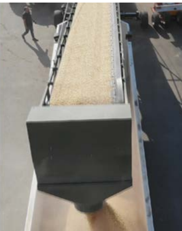
V-образная шевронная лента 1250 мм не повреждает семян.
