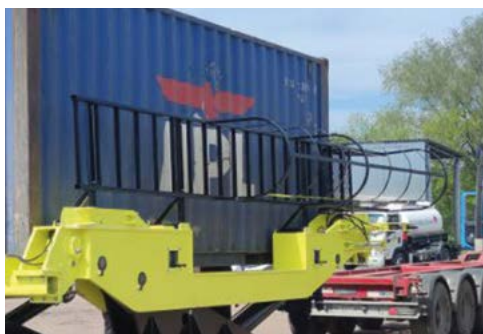
Лестница для обслуживания оператора
