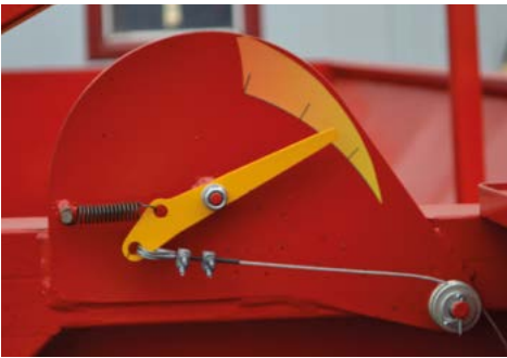
Шкала показатель открытия шиберной заслонки
