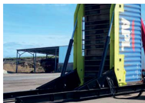
Cilindri idraulici rinforzati per sollevamento/abbassamento
