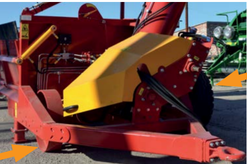
Opzione ruote anteriori aggiuntive per il trasporto del grano nella tramoggia della macchina BNP
