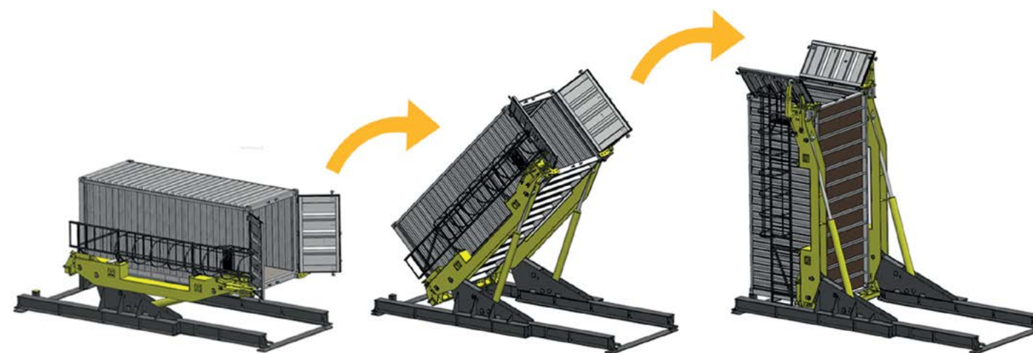
Processo di ribaltamento dei contenitori
