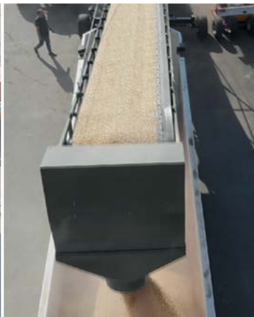
Il nastro chevron a V da 1.200 mm non danneggia i semi
