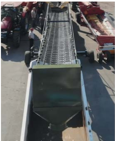
Il nastro chevron a V da 1.200 mm non danneggia i semi
