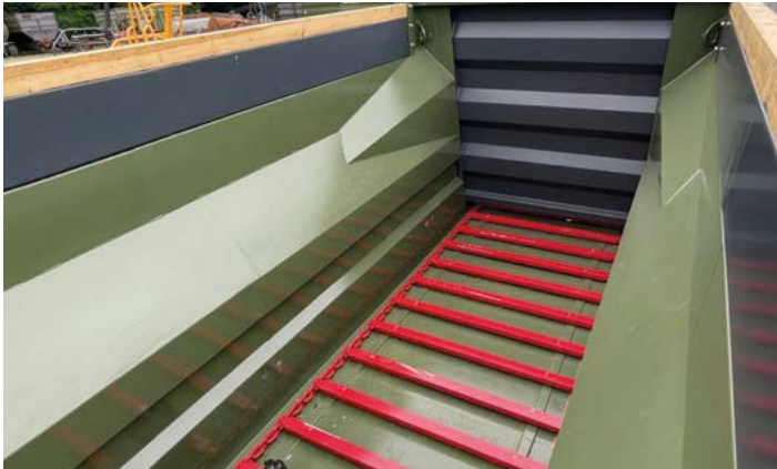
1.3 m wide apron conveyor.
