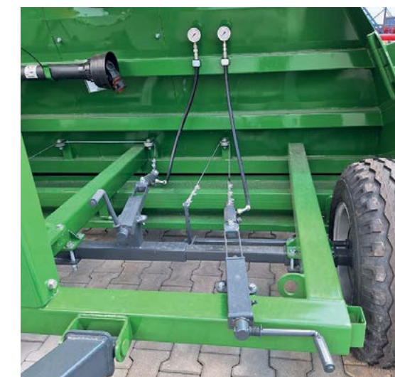
Nastavení tlaku brzdového systému pro každé kolo zvlášť
