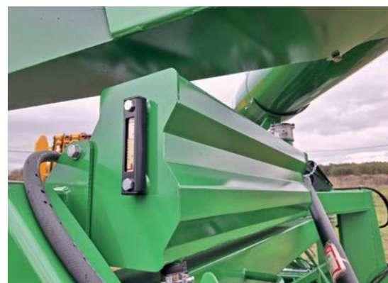
Přídavná olejová nádrž s teploměrem
