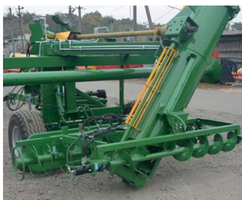
Přídavný horizontální šnek na kukuřici
