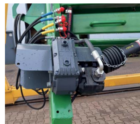
Samostatná dieslová stanice na ZRM-180. Pro zvýšení průtoku oleje na hydromotor.
