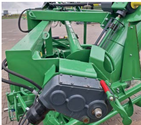
Mechanismus na navíjení a vyjímání vaku
