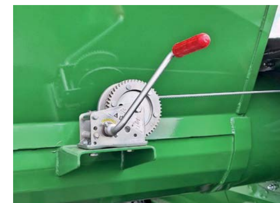
Ruční naviják pro zvedání vaku
