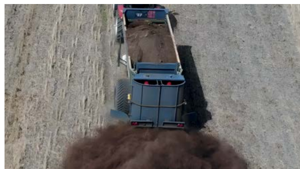
Внесение органических удобрений нижними пластинами – минимальная норма
