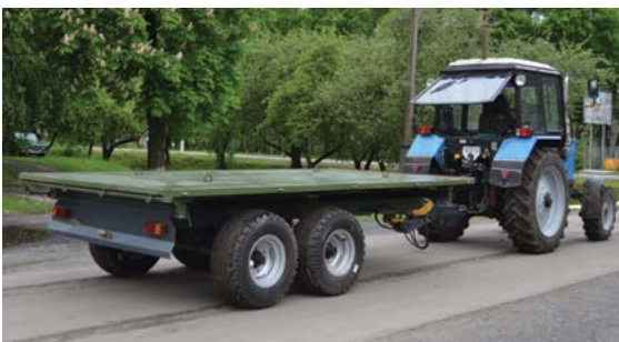
Прицепы с трехсторонней разгрузкой легко трансформируются в обычную платформу
