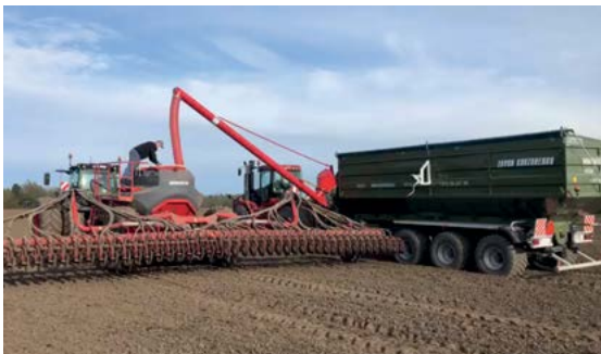
Шнек удлинитель ШРП для загрузки сеялок
