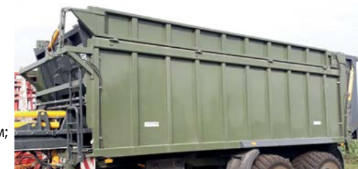
Опция. Боковой гидравлически-открывающийся борт h-400 мм
