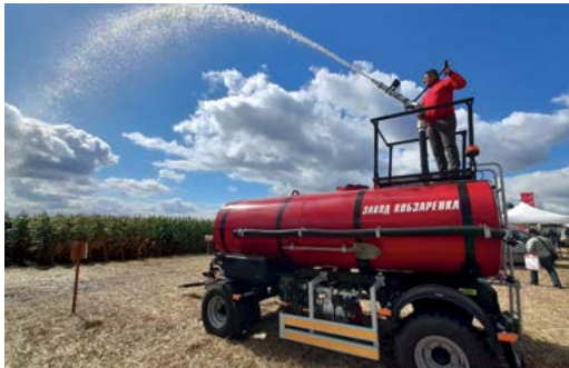
Пожарная цистерна ПЦ-6. V - 6 м³ Дальность потока воды на расстояние до 30 м. Комплектация насосом (работает от ВОМ трактора) или мотопомпой (работает стационарно)
