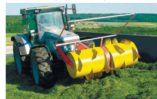
Уравнивательная машина для силоса РС-2400
