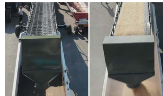
V-образная шевронная лента 1200 мм. не повреждает семена
