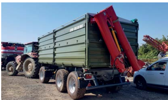
Задний борт адаптирован для перегрузочного шнека
