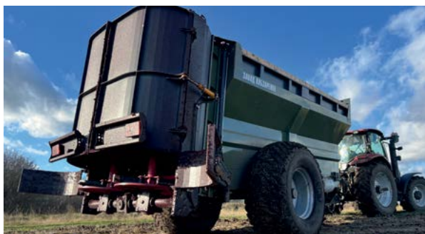
Задняя стенка открывается гидравлически
