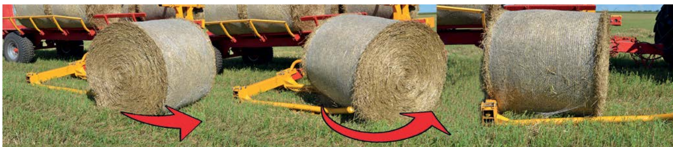
Универсальная гидравлическая лапа на ходу разворачивает рулон и загружает на платформу
