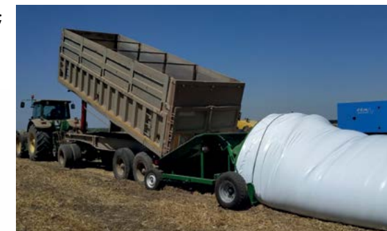
ЗПМ(А) -180 с пониженным бункером и электродвигателем. Загрузка от автомобиля.
