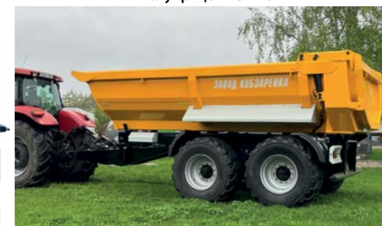
Полуприцеп ТСП-126 строительный из стали Hardox
