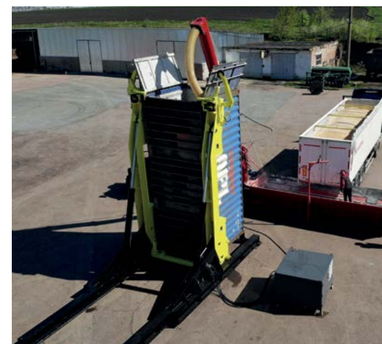
самостоятельно снимает и устанавливает контейнер прямо с контейнеровоза
