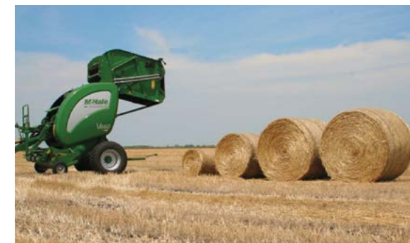
Автоматичне регулювання діаметру тюків в тюкопресі McHale V6740, V6750 - 0,68...1,68 м.
