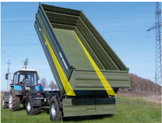
Конічний кузов унеможливилює зависання зеленої маси та гною
