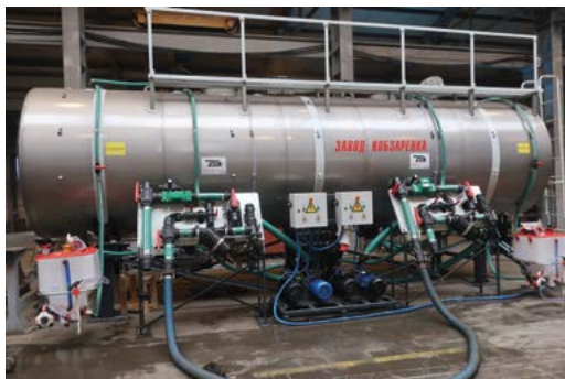
Стационарний розчинний вузол РЗС-20 з двома незалежними відсіками
