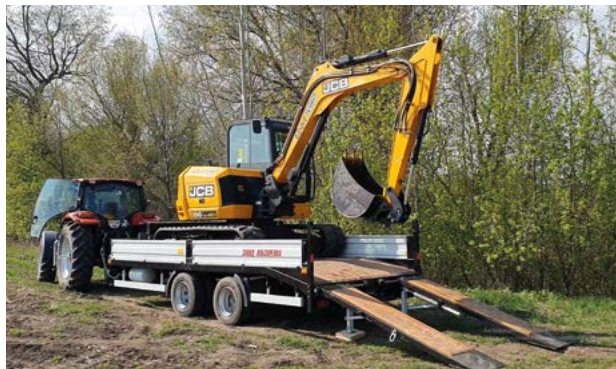
Низькорамний причеп ПС-12 для перевезення спецтехніки до 9т.
