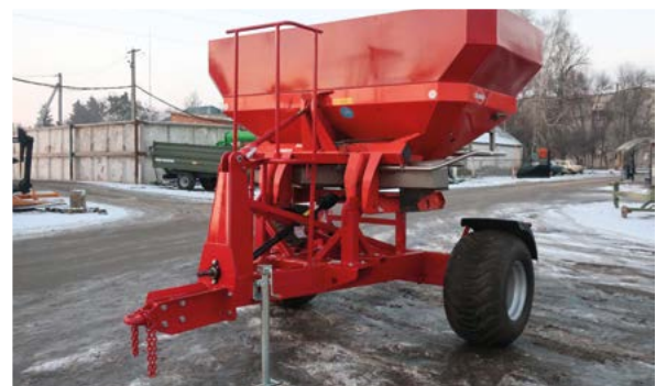
Візок (шасі) для перевезення навісних розкидачів мінеральних добрив
