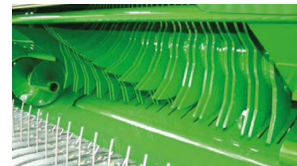
На тюкопресі McHale V6750 встановлено ріжучий блок з 15(25) ножами.
