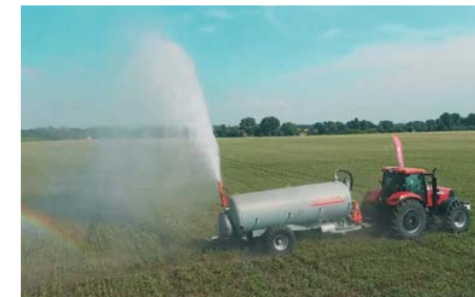
Гідро пушка для поливу та поверхневого внесення добрив, тушіння пожеж
