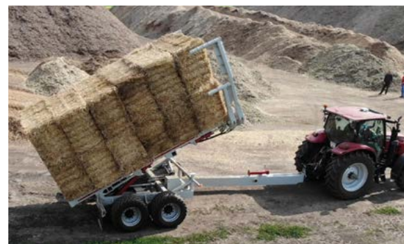
Розвантаження тюковоза на рівній і твердій поверхні займає 30-40 сек.
