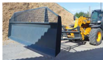
Подовжувач на телескопічний навантажувач для підгортання зерна, силосу, щепи, снігу
