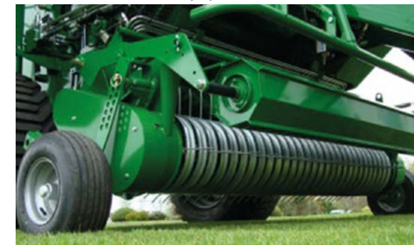
2,1-метровий оцинкований підбирач, що захоплює навіть найкоротші паростки
