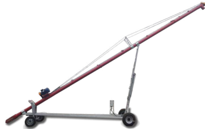
Стационарний шнек СШ-200/15 забір з кагату
