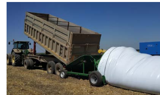
ЗПМ(А)-180 з пониженим бункером та електродвигуном. Завантаження від автомобіля.
