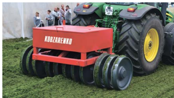
Каток - трамбувальник силосу СЛОН. Щільність силосу збільшується до 30% В комплектації ящик для піску, щебеню
