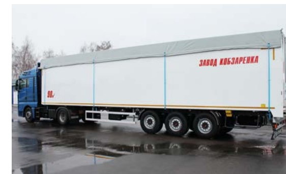
АРС-90 алюмінієвий щєповоз з рухомою підлогою Cargo Floor
