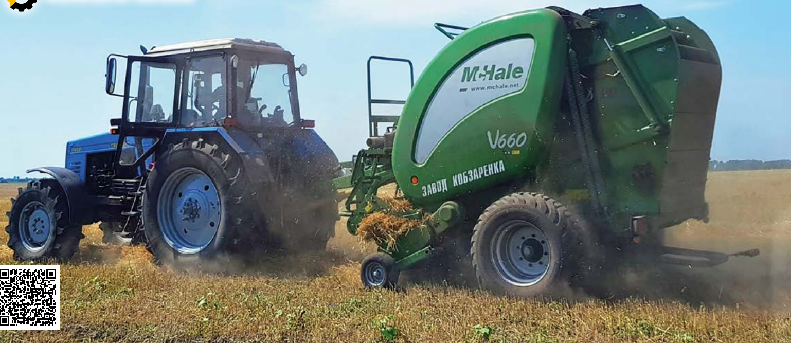
Автоматичне регулювання діаметру тюків в тюкопресі McHale V6740, V6750 - 0,68...1,68 м.
