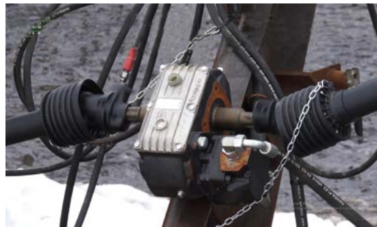
Автономна масляна станція на ЗРМ-180. Для збільшення потоку масла на гідромоторі.
