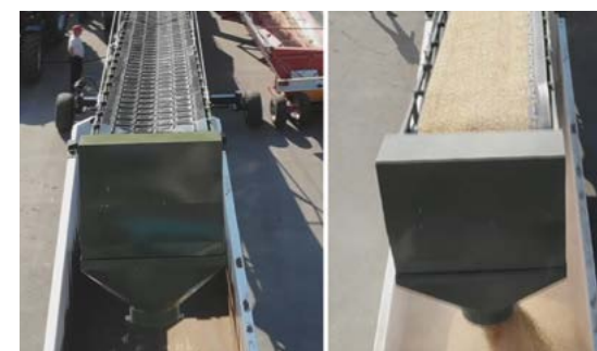
V-подібна шевронна стрічка 1200 мм не пошкоджує насіння
