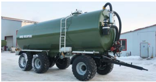
Цистерна з поворотним кругом - 26 м³
