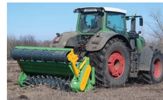
Розліснення земельних ділянок. Мульчер-фреза з трактором Case 380 к.с.
