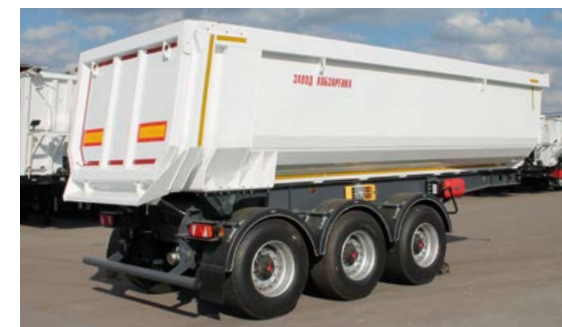
АСП-23. Автомобільний напівприцеп зі сталі Hardox
