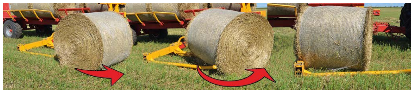
Універсальна гідравлічна лапа на ходу розвертає рулон та завантажує на платформу
