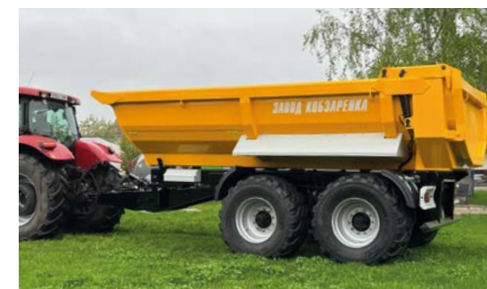
Напівприцеп ТСП-126 будівельний зі сталі Hardox
