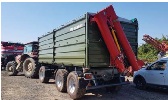
Задній борт адаптований для перевантажувального шнеку
