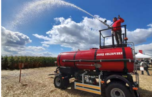
Пожежний цистерна ПЦ-6. V - 6 м³ Дальність потоку рідини до 30 м. У комплекті з насосом (працює від трактора) або мотопомпою (працює стаціонарно)
