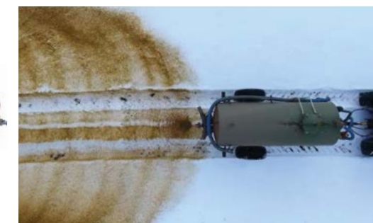
Ежекторний розподільник, внесення по снігу
