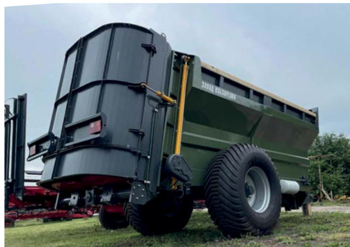
Zadní stěna se otevírá hydraulicky
