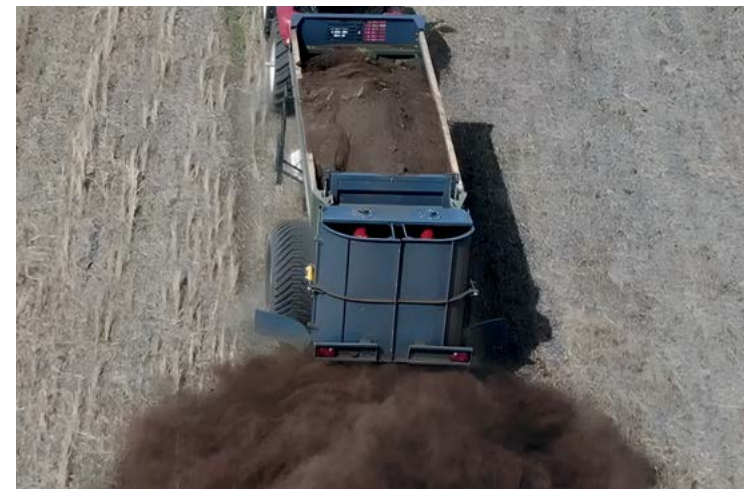
Aplikace organických hnojiv spodními talíři - minimální dávka
