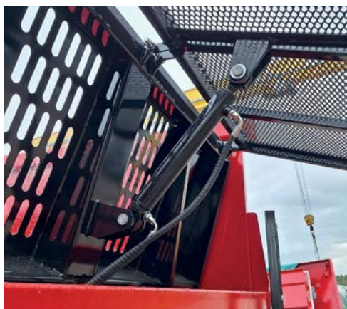
Hydraulicky otevírací síť na posuvné stěně
