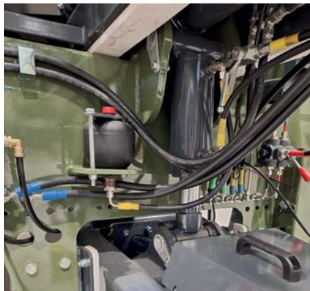
Oj s hydraulickým nastavením výšky traktoru a hydraulickým tlumičem s hydraulickým akumulátorem.
