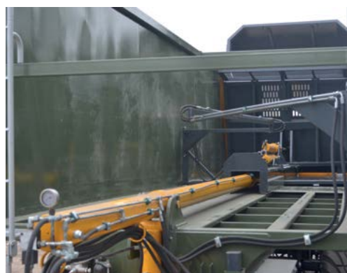
Hydraulický systém pohyblivé stěny
