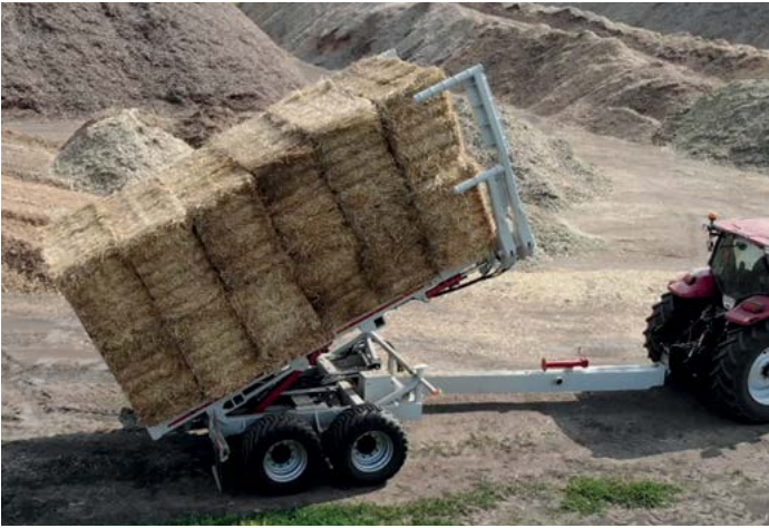
Vyložení balíkového návěsu na rovný a pevný povrch trvá 30-40 sekund
