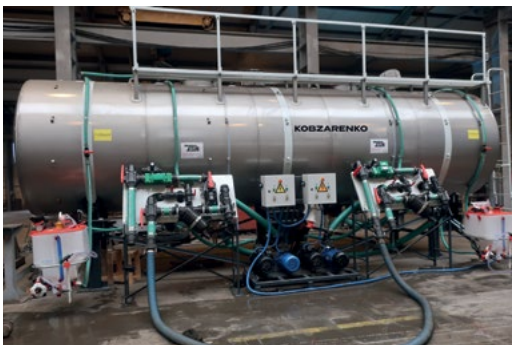
Стационарна минобачка јединица РЗС-20 са два независна одељка
