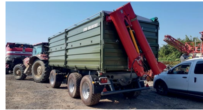
Пужови за причвршћивање на тракторске приколице
