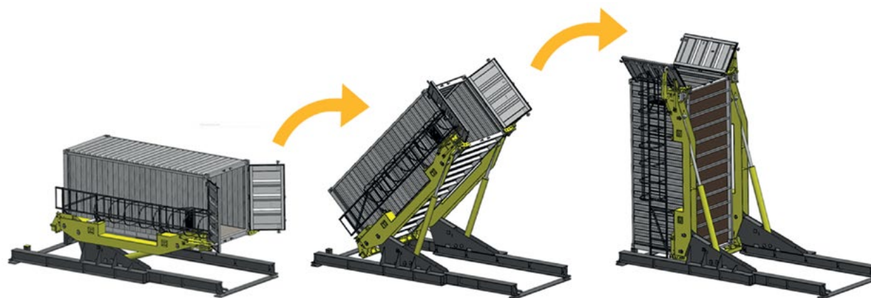
Процес преношења контејнера
