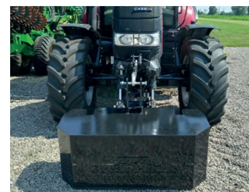
Тежина на полужју у три тачке трактора
