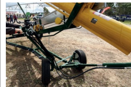
Додатна опција: механизам за окретање задњих точкова
