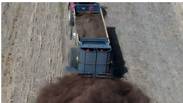
Вертикални ваљци за ширење
