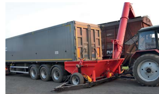
BNP-3 na utovaru vagona paralelno sa vagonom
