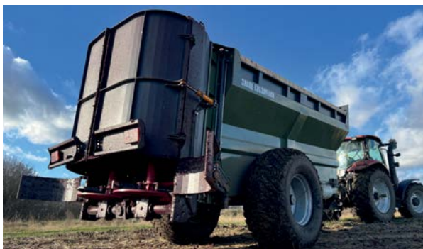
Zadnji zid se otvara hidraulično
