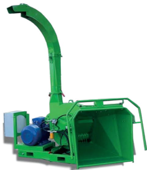
26 Sjekačica za grane RM-900 pogonjena priključnim vratilom traktora ili električni pogon od 55 kW
