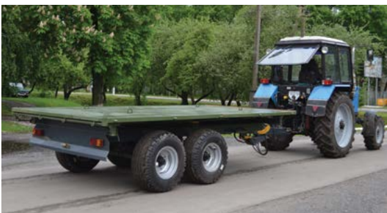
Trostrane prikolice za istovar lako se mogu transformisati u konvencionalnu platformu
