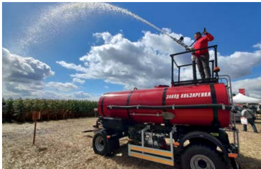
Vatrogasna cijev PC-6. V - 6 m 3 Uvođenje fluidnog pištolja do udaljenosti od 30 m U kompletu sa pumpom (radi iz traktora) ili motornom pumpom (radi stacionarno)
