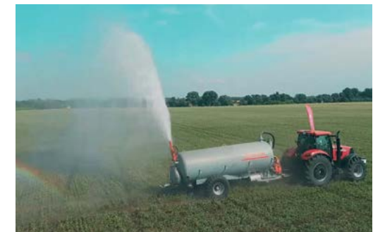
Hidro pištolj za navodnjavanje i površinsku gnojidbu, gašenje požara
