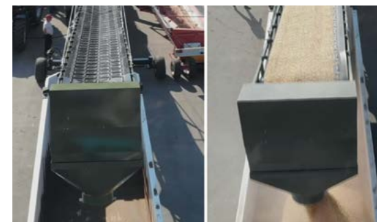
Ševron remen u obliku slova V 1200 mm ne oštećuje zrno
