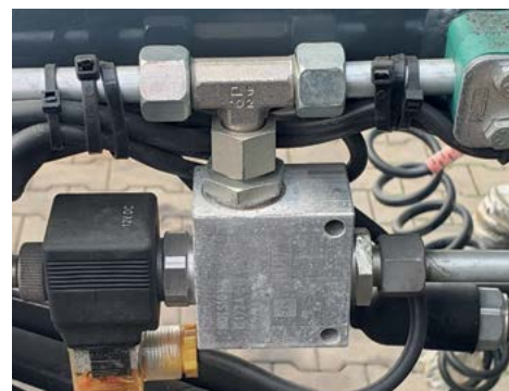
Хидравличен вентил за блокиране на отварянето на шибърния клапан при фиксиран BOM
