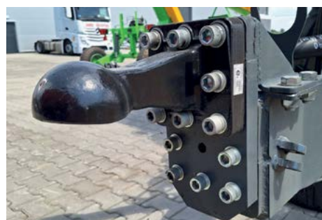
Адаптер за регулиране на височината на теглича към всеки трактор
