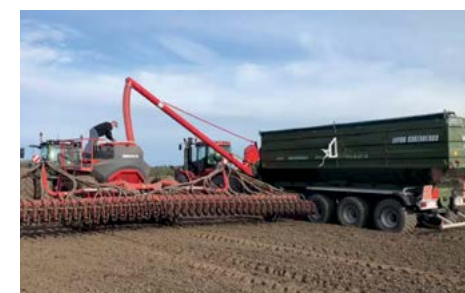
Зареждане на сеялки през PVC маркуч
