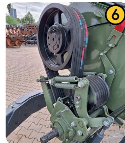
Отделно задвижване с алтернативно включване на шнекове. Задвижването на вертикалния шнек е директно през скоростната кутия, на хоризонталния шнек - чрез ремъчната трансмисия
