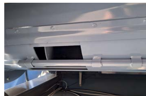
Три капака за почистване на хоризонтален шнек
