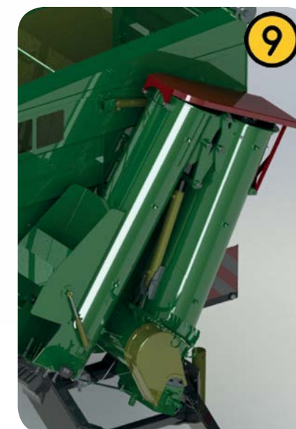
Защитен капак на шнека срещу валежи
