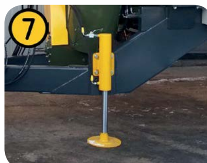
Хидравлична опора на теглича
