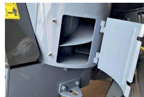
Един люк за почистване на вертикален шнек
