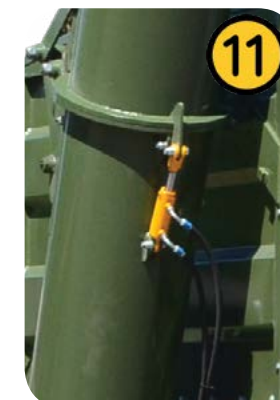
Хидравлично заключване на две шнекови части
