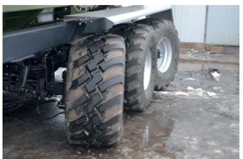
Хидравлично управление на първата и последната ос (PBN-40 и PBN-50).
