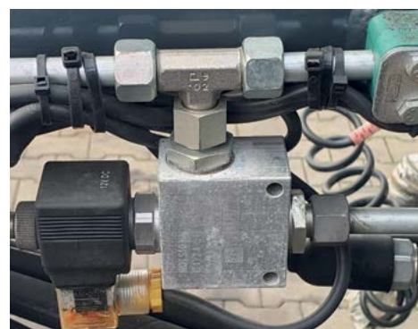
Hydraulický ventil pro blokování otevření posuvné brány u pevného PTO
