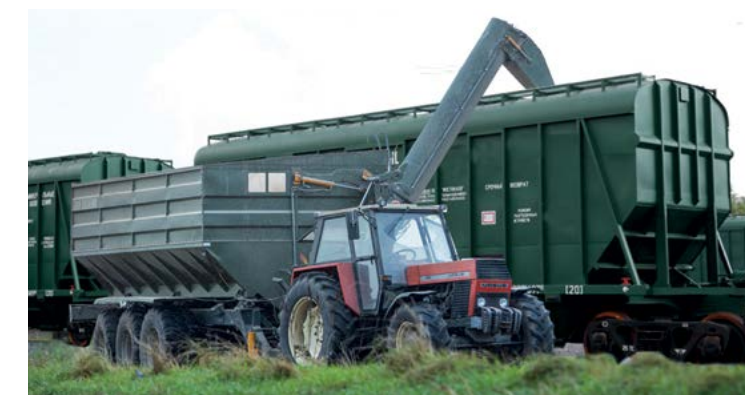
Prodloužený šnek h-5,5 m pro nakládací vozy
