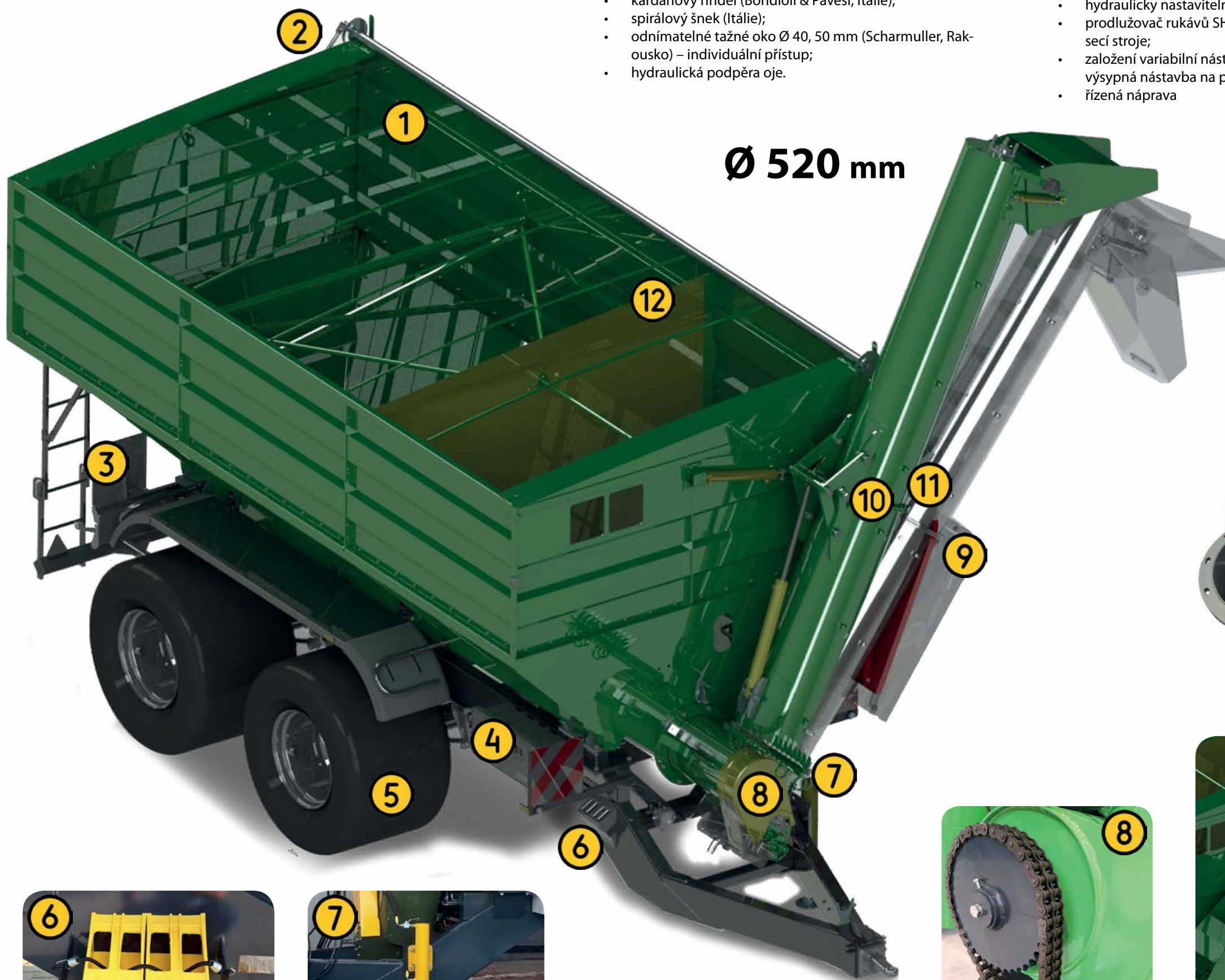
Boky karoserie jsou k sobě staženy výkonnými profilovými rozpěrami
