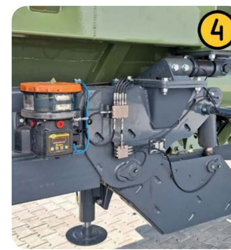
Programovatelný počítač s přesným intervalem mazání ložisek
