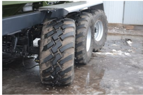
Hidrauliškai vairuojama pirma ir paskutinė ašis (PBN-40 ir PBN-50)
