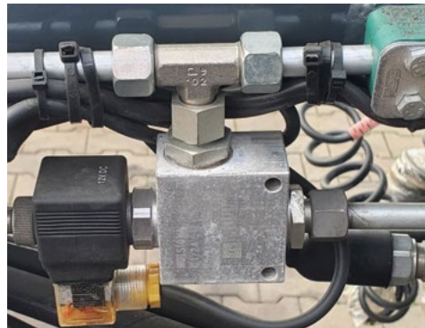
Hidraulinis vožtuvas, ribojantis sklendžių atidarymą
