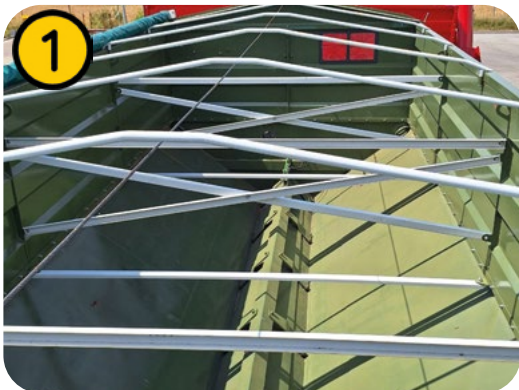
Puspriekabės šonai sutvirtinti tvirtais profiliais
