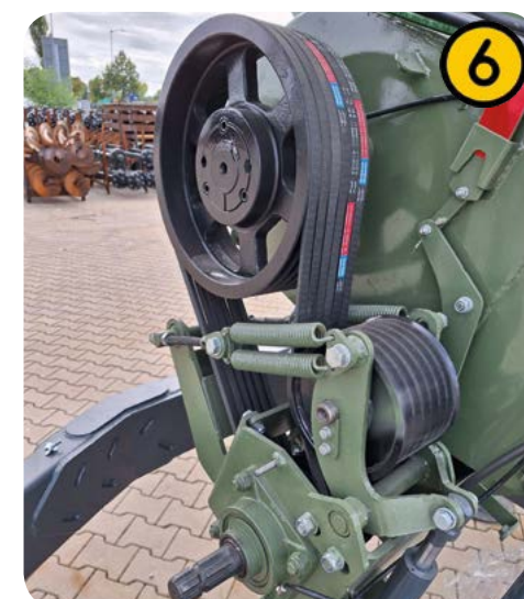
Azionamento separato con inclusione alternata di coclee. L'azionamento della coclea verticale avviene direttamente tramite il riduttore, della coclea orizzontale tramite la trasmissione a cinghia
