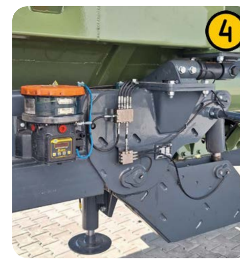
Computer programmabile con intervallo preciso di lubrificazione dei cuscinetti
