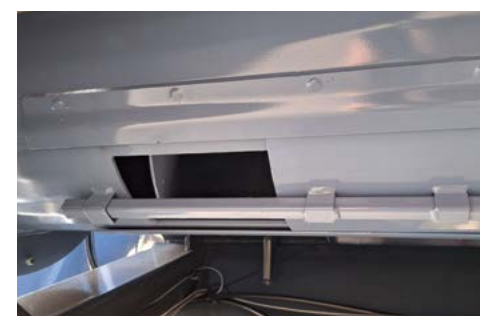
Tre alette di pulizia della coclea orizzontale
