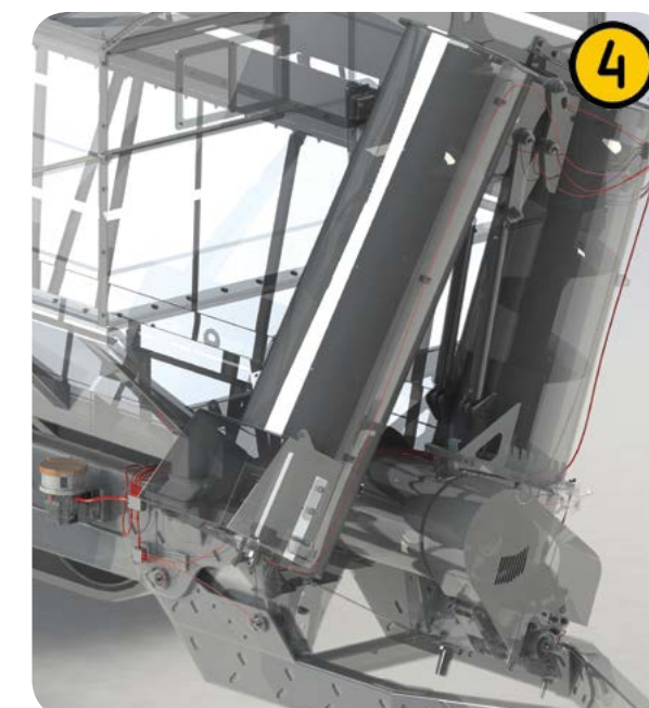
Sistema di lubrificazione centrale
