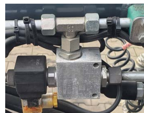
Valvola idraulica per blocco apertura cancello scorrevole a PTO fissa
