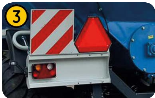
Illuminazione stradale del rimorchio secondo gli standard UE
