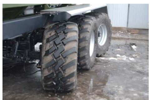
Un primo e ultimo asse sterzante idraulicamente (PBN-40 e PBN-50).
