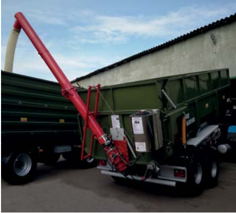
Šnek na přívěsu se zadním vykládáním
