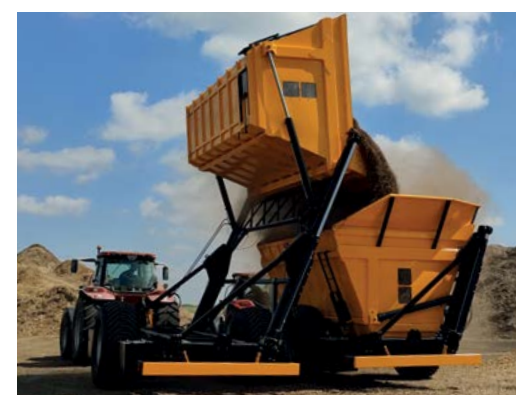
Maximální vykládací výška je 4 000 mm
