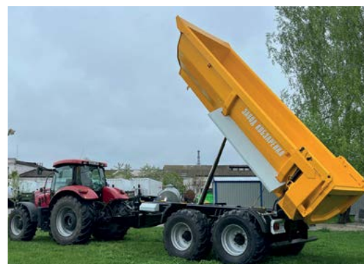
Teleskopický hydraulický válec DiNatale (Itálie)
