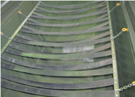
Tlumič pro padající brambory - gumové pásy
