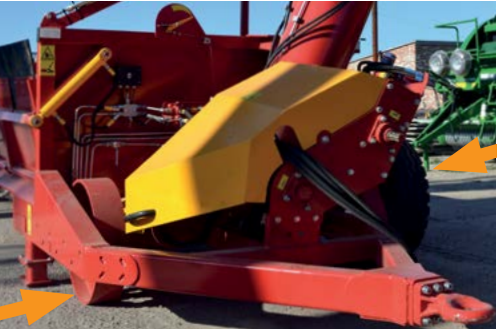
Možnost přidavných předních kol pro přepravu zrna v násypce stroje BNP
