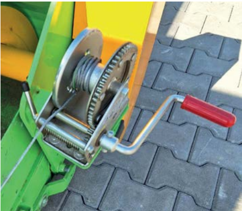
Naviják pro instalaci bočnic
