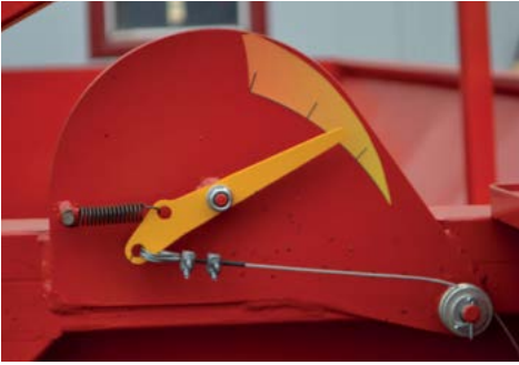
Stupnice, která ukazuje otevření posuvné clony
