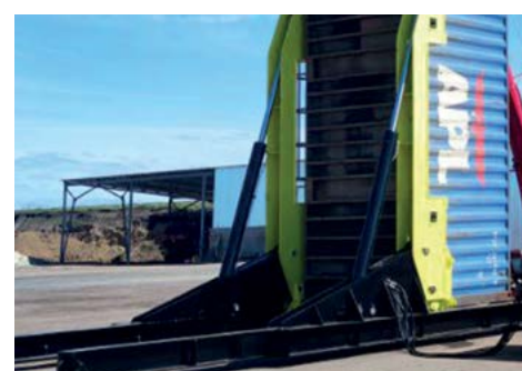
Vyztužené hydraulické válce pro zvedání / spouštění
