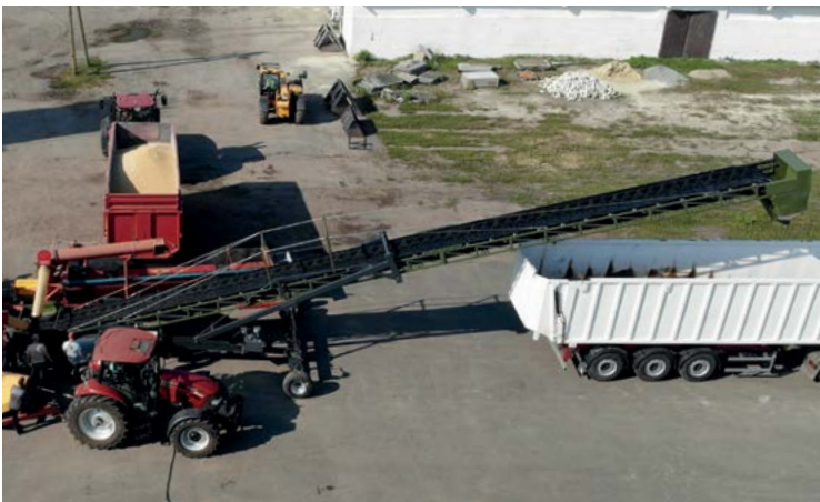
Délka dopravníku je 22m.
