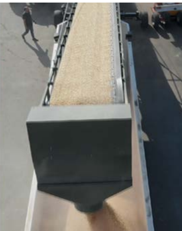
Ševronový pás ve tvaru V 1 200 mm nepoškozuje zrno
