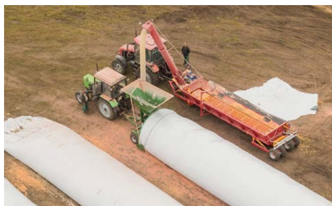
Utilizzo del BNP-12 «Kovheg» per la fornitura di grano nello ZPM-180
