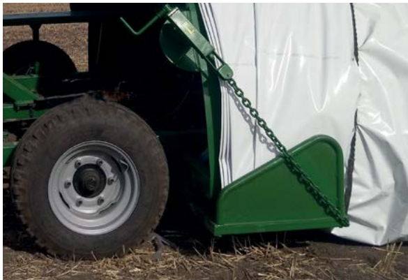
Regolazione del vassoio portasacco
