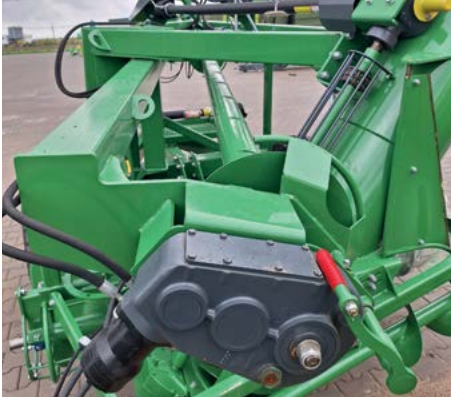
Meccanismo di avvolgimento e rimozione del sacchetto
