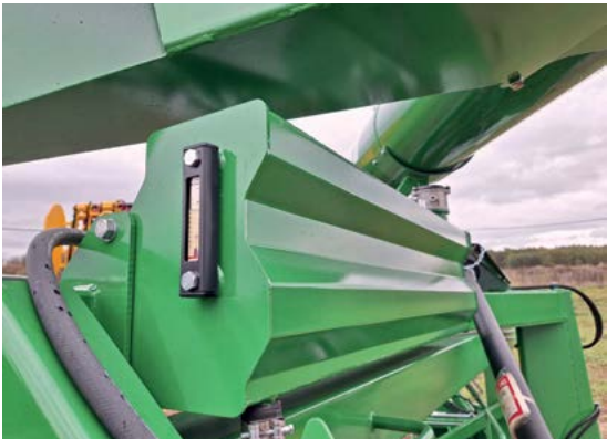
Serbatoio olio aggiuntivo con termometro
