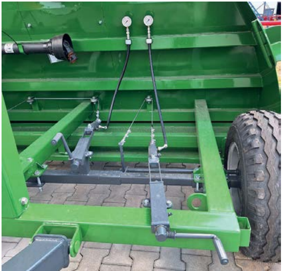
Regolazione della pressione dell'impianto frenante per ciascuna ruota separatamente
