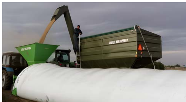
Utilizzo del PBN-30 per la fornitura di grano nello ZPM-180
