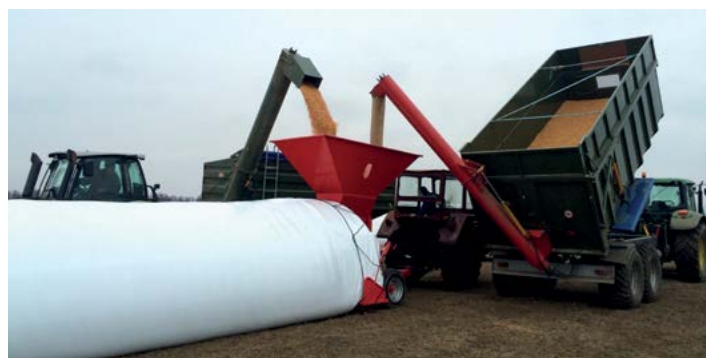
Coclea ripiegabile idraulicamente GRSH-300/4,5
