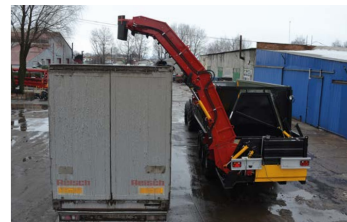
Ricaricatore di barbabietole fino ad un'altezza di 4,5 m.
