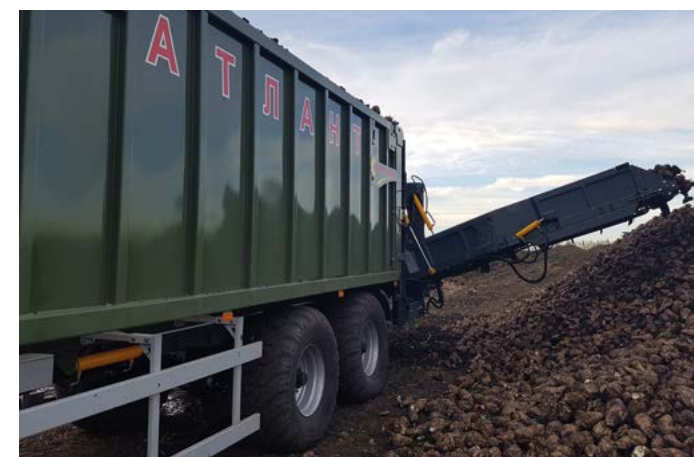
Accatastatore per barbabietole fino ad un'altezza di 3,0 m.
