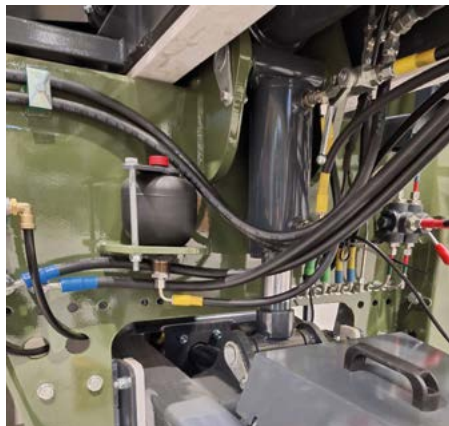
Timone con regolazione idraulica dell'altezza del trattore e ammortizzatore idraulico con accumulatore idraulico.
