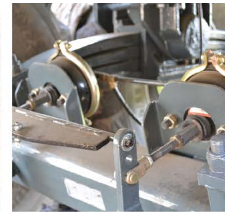
Sistema frenante ad aria compressa
