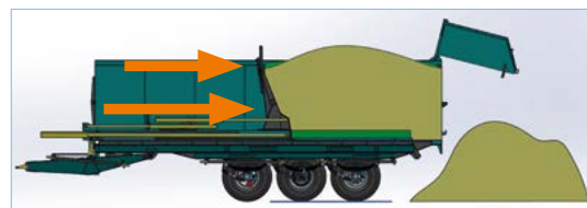
La metà del fondo si muove con la parete anteriore
