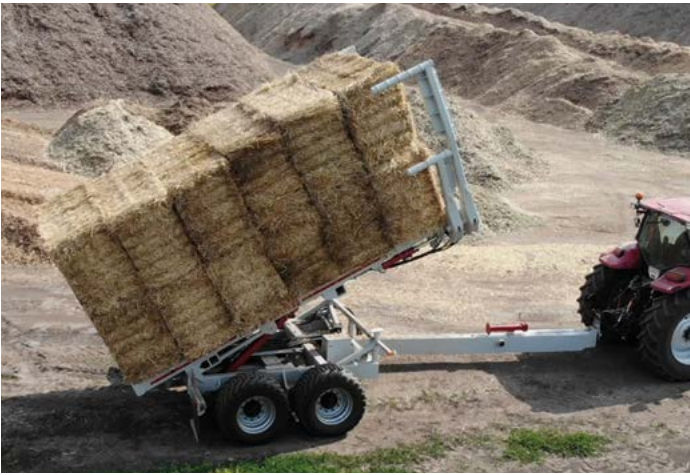
Lo scarico del semirimorchio per balle su una superficie piana e solida richiede 30-40 secondi
