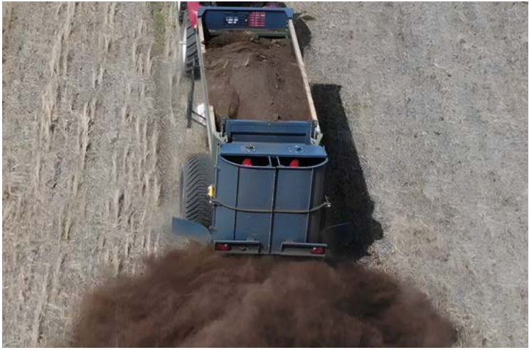
Внесение органических удобрений нижними пластинами – минимальная норма
