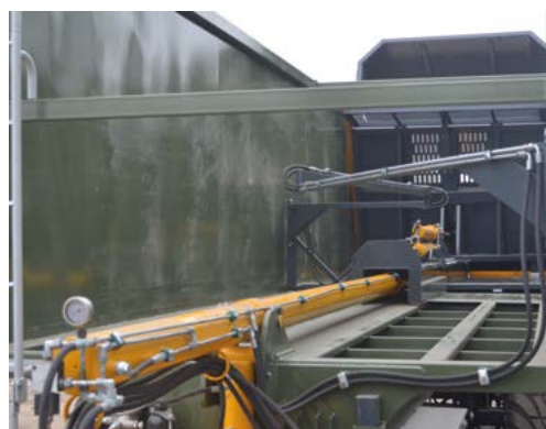
Гидравлическая система подвижной стенки
