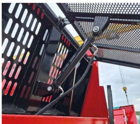
Гидравлически открываемая сетка на раздвижной стенке
