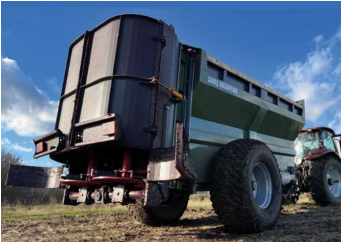
Задняя стенка открывается гидравлически
