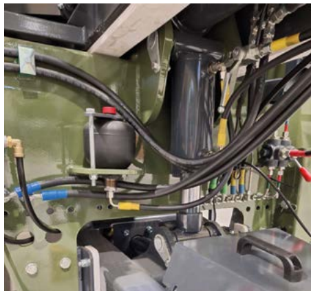
Дышло с гидравлической регулировкой высоты трактора и гидрозаслонки с гидроаккумулятором.
