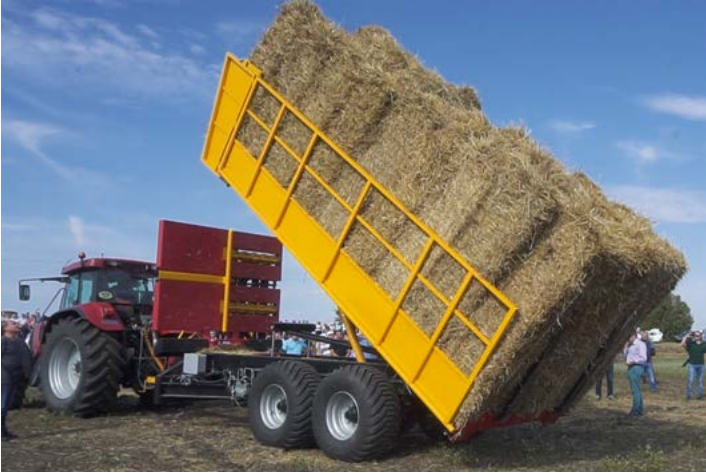
Разгрузка тюковоза на ровной и твердой поверхности занимает 30–40 сек.
