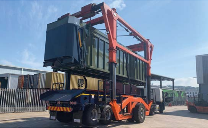
Кузов АЗП-60 установлен на шасси
