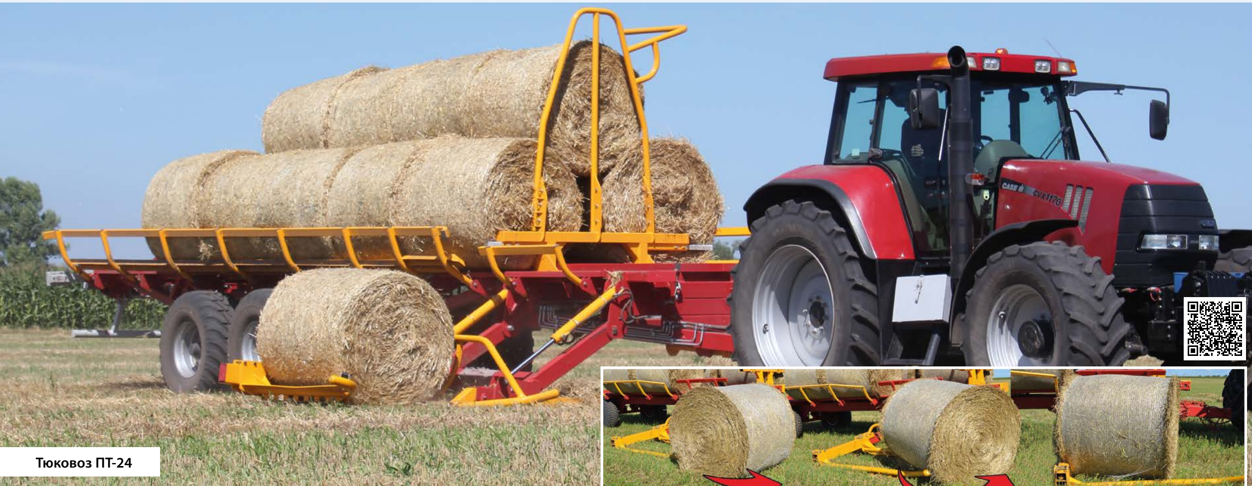
Универсальная гидравлическая лапа на ходу разворачивает рулон и загружает на платформу
