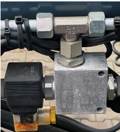
ХИДРАУЛИЧНИ ВЕНТИЛ ЗА БЛОКИРАЊЕ ОТВАРАЊА КЛИЗНИХ КАПИЈА КОД ФИКСНОГ ПТО
