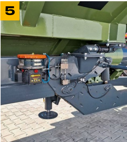
ПРОГРАМАБИЛНИ РАЧУНАР СА ПРЕЦИЗНИМ ИНТЕРВАЛОМ ПОДМАЗИВАЊА ЛЕЖАЈЕВА
