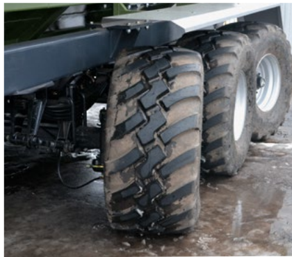
ПРВА И ПОСЛЕДЊА ОСОВИНА СА ХИДРАУЛИЧНИМ УПРАВЉАЊЕМ (ПБН-40 И ПБН-50).
