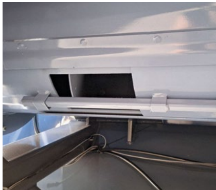
ТРИ ПОКЛОПЦА ЗА ЧИШЋЕЊЕ ХОРИЗОНТАЛНОГ СВРДЛА
