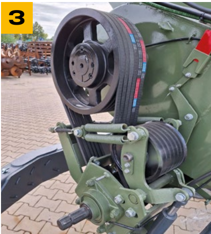
ОДВОЖЕНИ ПОГОН СА НАИЗМЕНИЧНИМ УКЉУЧИВАЊЕМ ПУЖА
