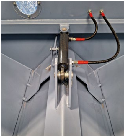
КЛИЗНА КАПИЈА КОЈА СЕ ОТВАРА ХИДРАУЛИЧКИ. УНОСИ ЗРНО У СВРДЛО.
