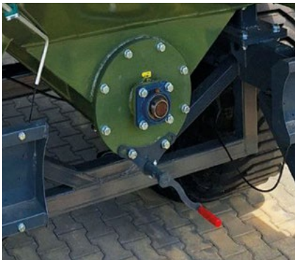
ВИЈЧАНИ МЕХАНИЗАМ ОТВАРАЊА ХОРИЗОНТАЛНОГ ПОКЛОПЦА ЗА ЧИШЋЕЊЕ ПУЖА
