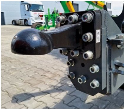
АДАПТЕР ЗА ПОДЕШАВАЊЕ ВИСИНЕ ЗА ПРИКЉУЧИВАЊЕ НА БИЛО КОЗИ ТРАКТОР
