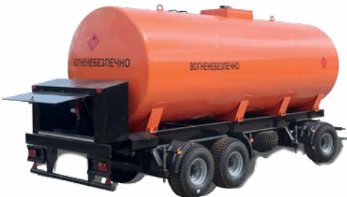
Serbatoio di riempimento per gasolio
