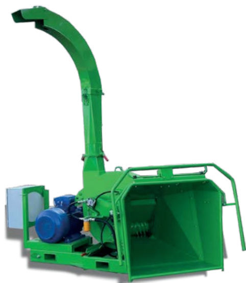
Trinciarami RM-900 alimentato dalla presa di forza del trattore o motore elettrico da 55 kW
