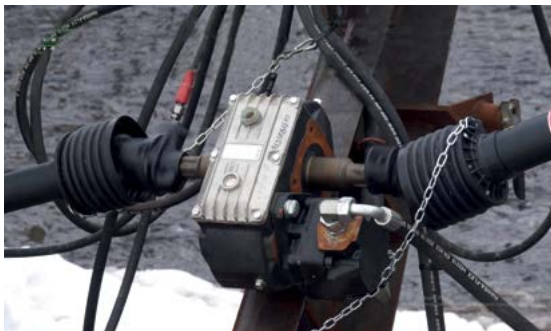
Stazione petrolifera autonoma su ZRM-180. Per aumentare il flusso di olio sul motore idraulico
