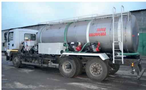
Installazione di RZS sul telaio dei camion
