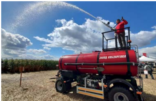
Barile da fuoco PC-6, V - 6 m³ L'introduzione della pistola per fluidi fino ad una distanza di 30 m Completo di pompa (funziona da trattore) o motopompa (funziona da stazionario)
