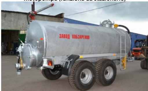
Zincatura a caldo. Strato zincante 100-300 micron
