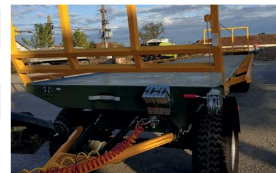
Verricello e allargamento piattaforma a 3 m
